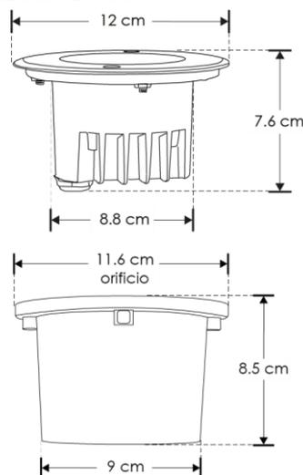
Este producto es usado como elemento de iluminación para luz de cortesía en pisos, jardines y áreas exteriores. Es de empotrar en piso, para uso. Incluye housing, sensor de oscuridad, batería y celda solar.
