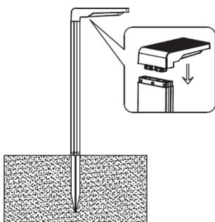
1. Coloque la estaca en el poste. Fije el cabezal al poste. Entierre la estaca en el piso.
