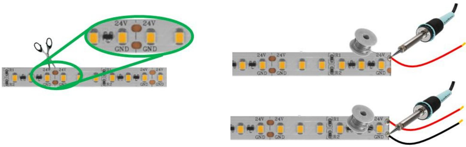
En caso de requerir ajustar la longitud del luminario, puede cortar la banda metálica y la tira de LEDs (cada 3.3 cm). Haga perforaciones en la banda metálica usando un taladro y broca para sujetar en los soportes.
