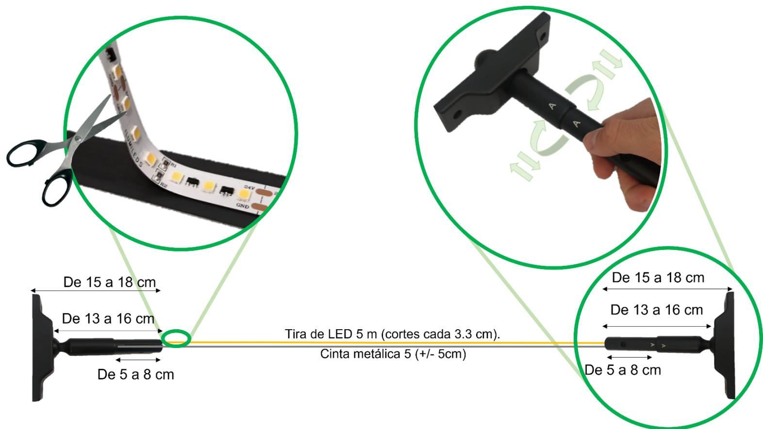
Limpie perfectamente la banda metálica usando gasolina blanca y tela de microfibra. Deje secar y asegúrese que no quedan restos de polvo, grasa o cualquier objeto que pueda afectar la disipación de calor de la tira de LEDs. Después retire la cubierta protectora de la banda metálica. Pegue firmemente la tira de LEDs en la banda metálica, en caso de ser necesario corte el excedente de tira.
