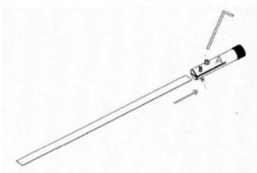
6. Asegure la cinta metálica a los soportes usando los tornillos allen.
