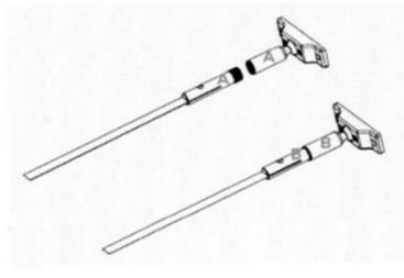
7. Asegure ambos extremos de la cinta a los soportes laterales. Y ajuste la tensión.
