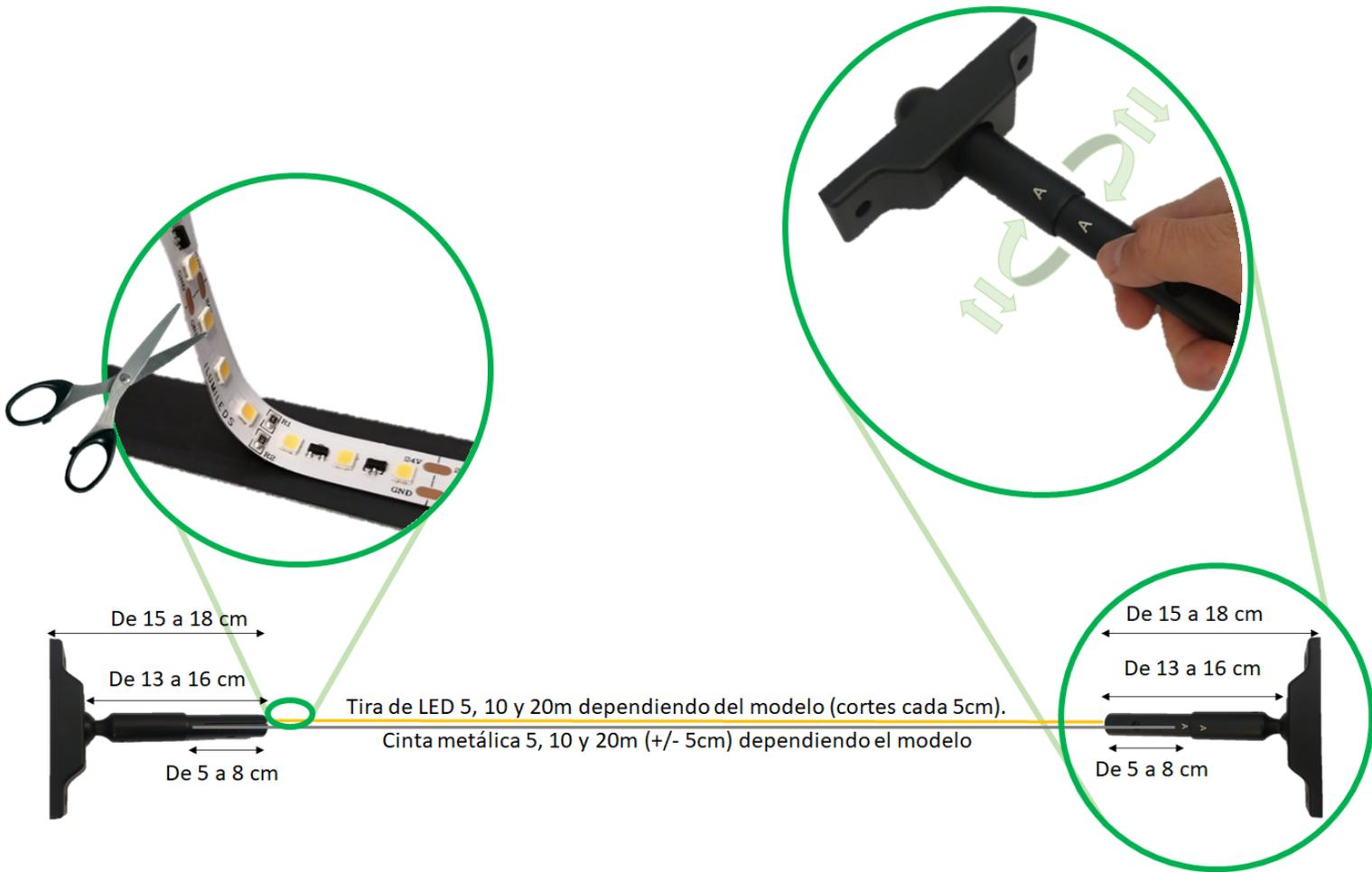
Limpie perfectamente la banda metálica usando gasolina blanca y tela de microfibra. Deje secar y asegúrese que no quedan restos de polvo, grasa o cualquier objeto que pueda afectar la disipación de calor de la tira de LEDs. Después retire la cubierta protectora de la banda metálica. Pegue firmemente la tira de LEDs en la banda metálica, en caso de ser necesario corte el excedente de tira.
