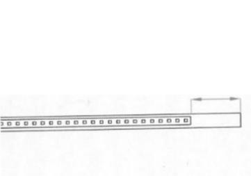
5. Pegue la tira de LED en la cinta metálica. Deje espacio para fijar la banda con los soportes en los extremos.
