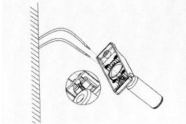
2. Conecte los cables de salida de la fuente de poder (24 V  $\overline{=}$ ) en las terminales del soporte lateral con conector.
