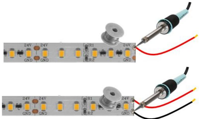
En caso de requerir ajustar la longitud del luminario, puede cortar la banda metálica y la tira de LEDs (cada 5cm). Haga perforaciones en la banda metálica usando un taladro y broca para sujetar en los soportes.
