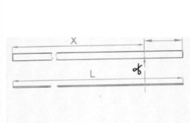
4. Mida la distancia (L) entre las paredes donde se instalarán los soportes (puede usar un cable de acero o hilo como guía) y la distancia de corte de la tira (X).
