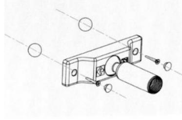
3. Inserte la varilla rotatoria en el orificio de la base metálica.
