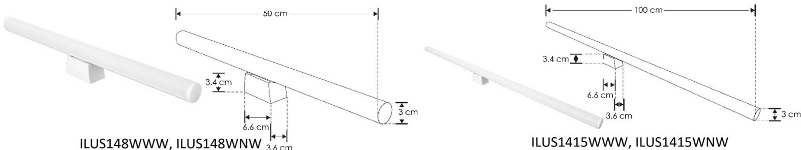
Luminario para pared tipo liniestra utilizado como elemento de iluminación sobrepuesto en muro. Conexión directa a la línea eléctrica. No requiere controlador (driver) externo.
