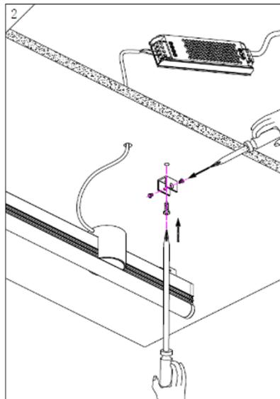
2. Pase los cables de alimentación y conéctelos a la fuente de poder de 24V cc respetando la polaridad correcta
