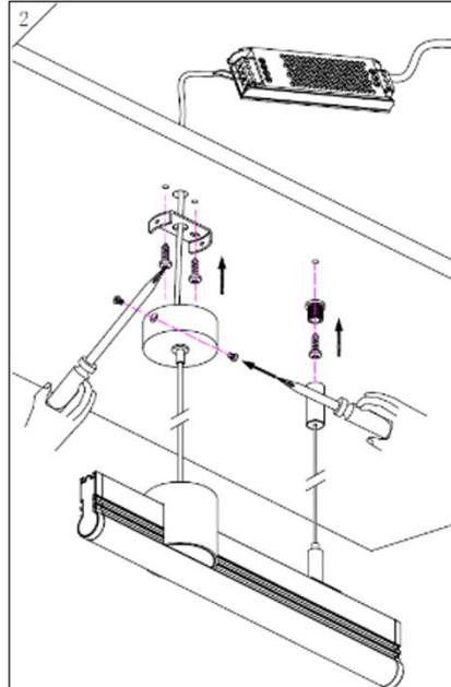
2. Fije los soportes y ajuste los cables de acero de acuerdo con las medidas deseadas.
