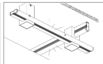
Para hacer acoplamiento con los accesorios RVSCOPX y RVSSUJSOB apague la energía eléctrica de la fuente de poder e inserte los luminarios como se observa en la figura.
