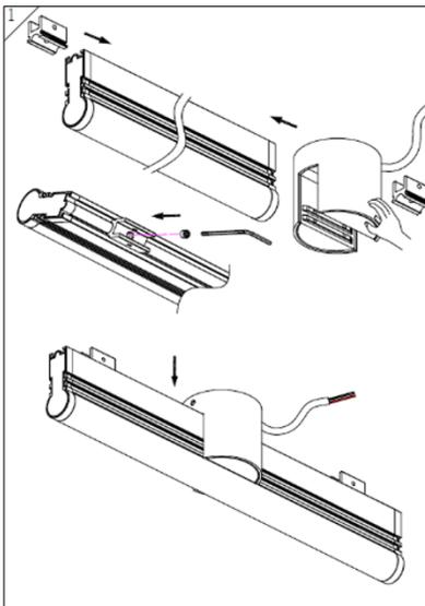
1. Inserte la grapa de fijación en la parte trasera del luminario. Ubique el conector con cable modelo RVSCONCAB en su posición
