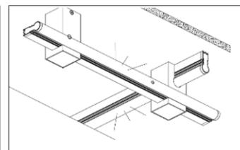
Para hacer acoplamiento con los accesorios RVSCOPX y RVSSUJSOB apague la energía eléctrica de la fuente de poder e inserte los luminarios como se observa en la figura.
