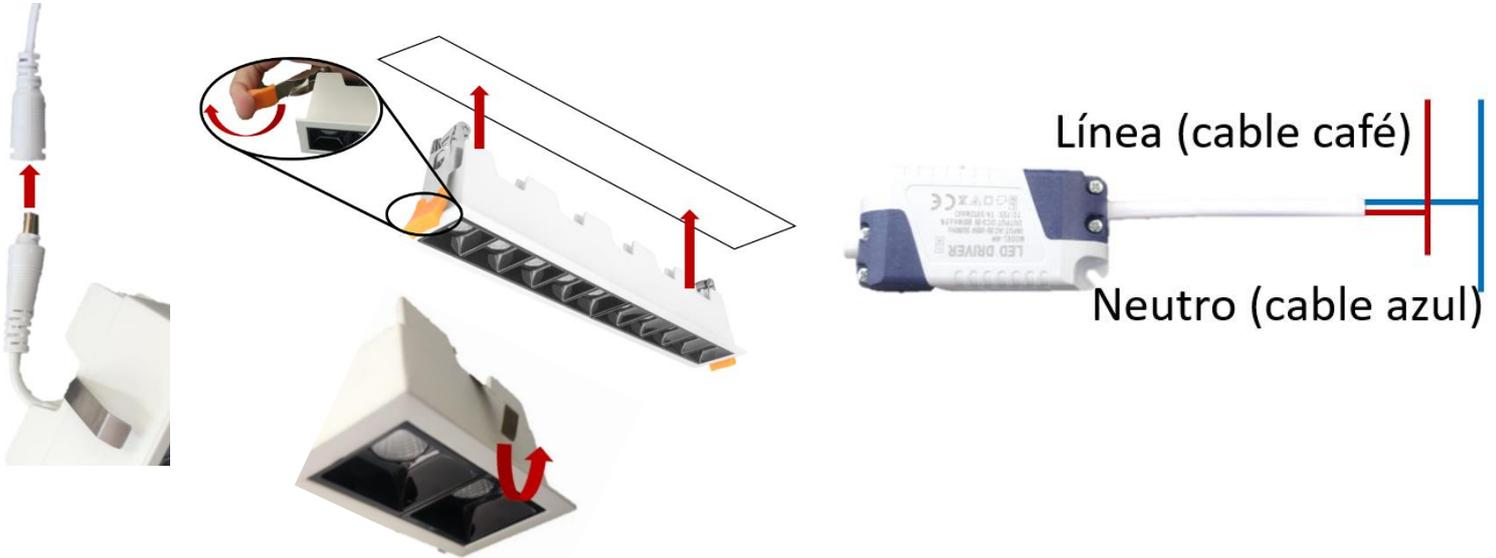
Para convertir el luminario en atenuable, es necesario reemplazar el controlador (driver) original por los modelos según la siguiente tabla. Se debe considerar que al cambiar el controlador (driver) original, el voltaje de alimentación cambia de acuerdo con las especificaciones del controlador (driver) atenuable. Consulte la ficha técnica del controlador (driver) atenuable:
