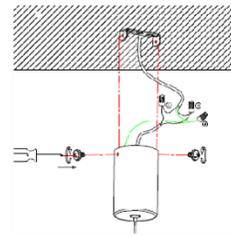
3. Realice las conexiones y aisle perfectamente.
