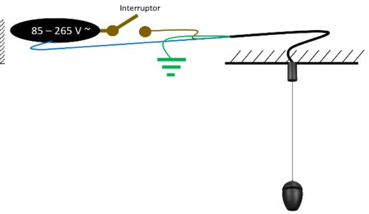
4. Fije el canope a la base de sujeción y pase los cables de alimentación por el techo. Encienda la energía eléctrica y pruebe su funcionamiento.
