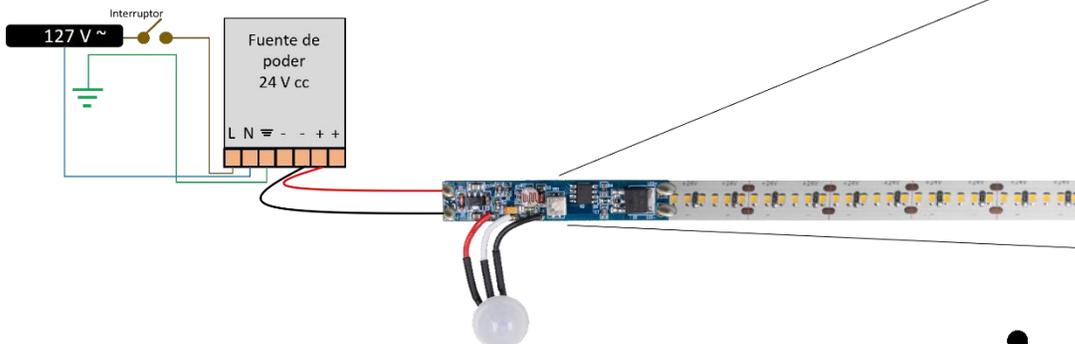
Instale el sensor dentro del perfil de aluminio, dejando solo el lente expuesto:
