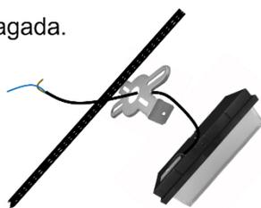
4. Pase los cables de alimentación por un orificio a través del muro y a través de la base. Conecte al luminario. Aísle perfectamente.
