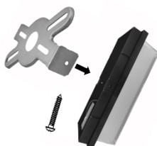
6. Fije el cuerpo del luminario a la base de sujeción usando el tornillo lateral.
