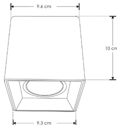
Este producto es usado como difusor de lámparas o módulos de LED cuyo diámetro sea igual a 5 cm, incluye base MR16. Modelos de módulos compatibles: ILUMOD5WWIP54, ILUMOD5WWIP54, ILUMODPC7WW, ILUMODPC7WW
