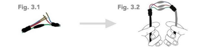
4.- Realice el aislamiento cubriendo la cinta vulcanizable desde el conductor de alimentación en dirección del cable de la luminaria.
