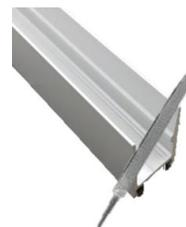
Para realizar figuras como marcos o ángulos a 90°, haga los cortes diagonales, para que, al unir los dos tramos de perfil de aluminio, se forme la figura deseada sin sombras ni obstáculos en el luminario terminado. Puede hacer cortes diagonales para que el luminario tenga luz frontal, interna, externa o intersección.
