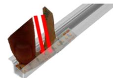
Conecte la tira de LEDs al cable de alimentación usando un cautín de lápiz y soldadura de estaño para soldar en las terminales indicadas (Ver manual de operación de la tira de LEDs o regleta de LEDs utilizada).
