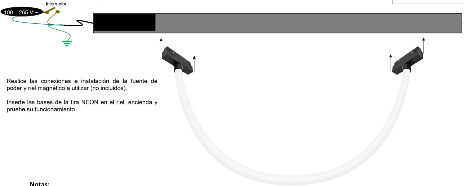
Realice las conexiones e instalación de la fuente de poder y riel magnético a utilizar (no incluidos).
