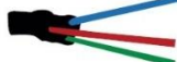
Fig. 1.4 Con los pasos anteriores se generó un sello que evitará el paso de humedad.
