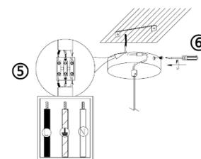
5. Realice las conexiones a la línea eléctrica.
