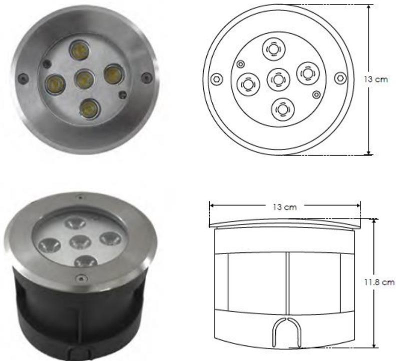
Este producto es usado como elemento de iluminación para luz en pisos, jardines, muros, columnas y áreas exteriores. Disponible en 5 LEDs de 1 W c/u blanco cálido. Voltaje de alimentación 100-240V ca sin necesidad de controladores (drivers) o transformadores externos.
