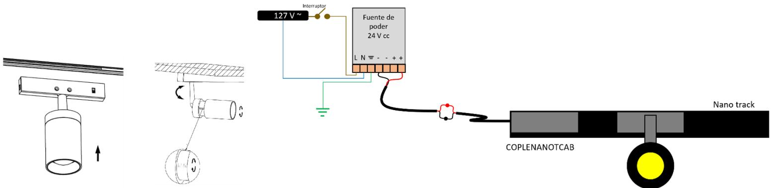
1. Inserte el luminario en el nano track y ajuste el ángulo de apertura hasta tener el efecto deseado.
