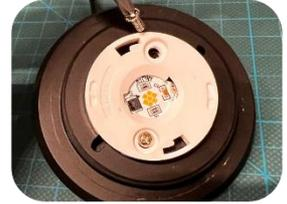
4. Retire los tornillos que sujetan la base del LED.
