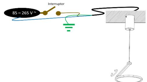
4. Fije el canope a la base de sujeción y pase los cables de alimentación por el techo. Encienda la energía eléctrica y pruebe su funcionamiento.
