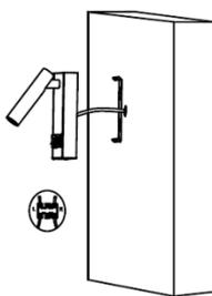
2. Pase los cables de alimentación a través del orificio central de la base y a través del muro. Realice las conexiones.
