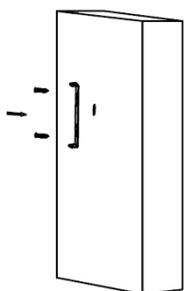
1. Verifique que la energía eléctrica esté desactivada. Fije la base de sujeción a la superficie donde va a instalar el luminario.
