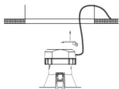
2. Levante la tapa del luminario e inserte los cables de conexión. Coloque el luminario (ILUMODPC8WWW, ILUMODPC8WNW o ILUMODPC8WW) en el difusor por la parte trasera.
