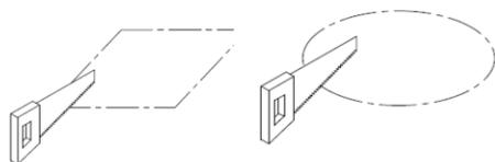
1. Haga un orificio en el plafón o superficie a instalar del tamaño necesario según las especificaciones del difusor.
