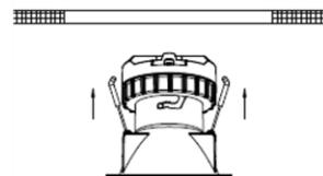
3. Inserte el difusor con el luminario en el orificio y asegúrelo con los soportes laterales. Encienda y pruebe su funcionamiento.
