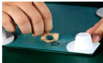
3. Retire la protección del adhesivo y pegue el sensor en el espejo
