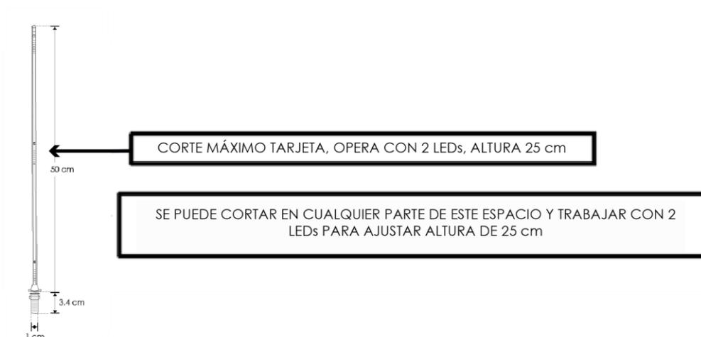
No es posible cortar más el poste pues no funcionará, hacer el corte en otra parte producirá una falla como parpadeo o que los LEDs se puedan dañar.
