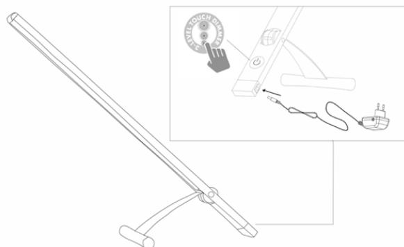
pulse el botón de encendido que está abajo del brazo de la luminaria aumentará o disminuirá la intensidad de la luz, así como su apagado.
