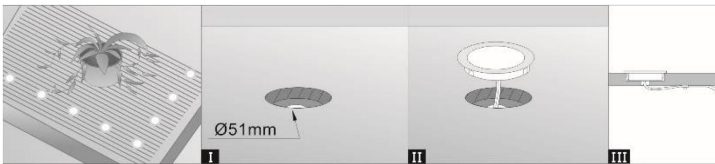
1. Identifique el lugar a instalar el luminario y asegúrese que sea el adecuado para este tipo de luminario. Se recomienda que el piso sea firme como madera, acero, losetas, etc. En caso de instalarse directamente sobre concreto o cemento se recomienda el uso de un tubo de acero, PVC u otro material para que sirva de housing de este luminario.
