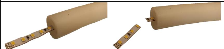
3. Solde el cable de alimentación y aisle 1cm de tira de LED. (ver manual de operación de tira NEON).
