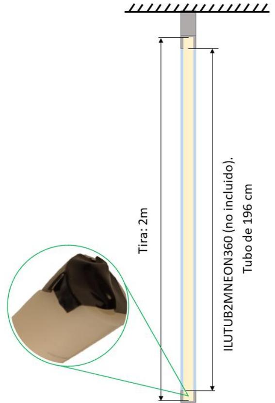
1. Inserte el empaque en los soportes. Inserte el cable de alimentación de la tira NEON por el interior del soporte.
