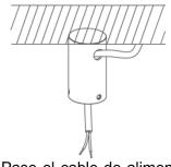
2. Pase el cable de alimentación a través del orificio lateral del cilindro.
