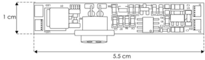
Utilizado como sensor con función de apagado y encendido de tiras extraplanas del tipo monocromático activado con puertas.
