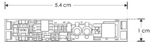
Utilizado como sensor IR (Infrarrojo) para apagar y encender tira de LEDs extraplanas del tipo monocromático en perfiles de aluminio preferentemente.
