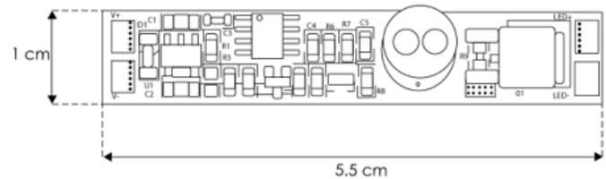
Utilizado como atenuador de intensidad de luz (dimmer) con función de apagado y encendido de tiras extraplanas del tipo monocromático activado con la mano.
