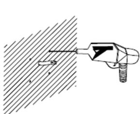
1. Haga las perforaciones para fijar la base del luminario y para pasar el cable de alimentación a través del muro
