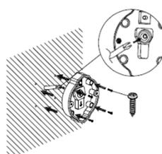
3. Realice las conexiones y aisle perfectamente. Cierre la base del luminario.
