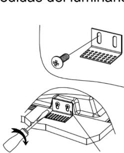
2. Coloque los soportes de acuerdo con la profundidad requerida por el material del recubrimiento final.
