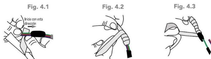
5.- Recubra todo aislamiento con la cinta vinil del cable de alimentación en dirección al cable de la luminaria.
