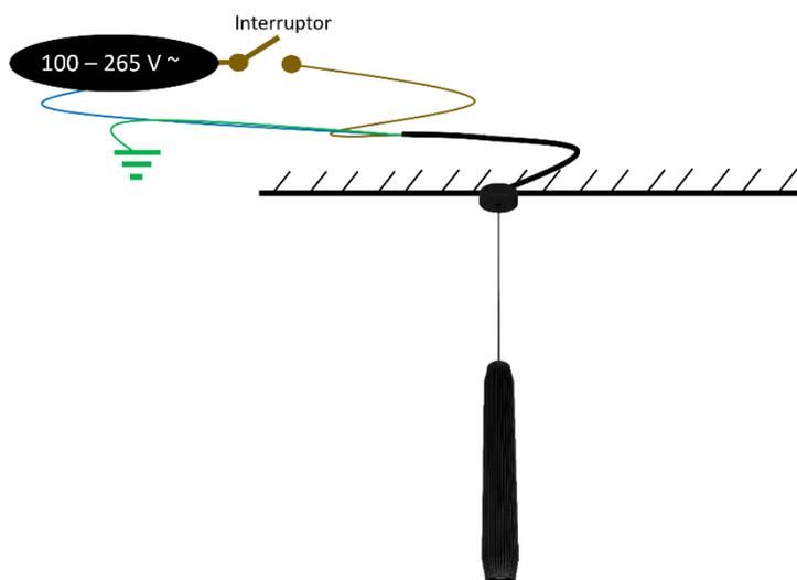
Para instalación en exteriores se recomienda usar el siguiente método de aislamiento:
