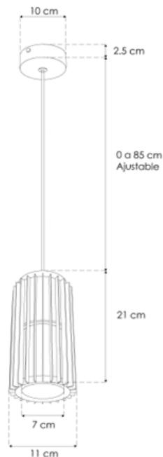
Este producto se usa como elemento de iluminación suspendido en techo, incluye base G9 (no incluye lámpara). Características de la base G9 incluida: 100 – 265 V ~ 50/60 Hz 15 W (0.15 – 0.06 A) máximo.
