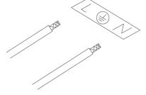
Conecte los cables de eléctrica alimentación al luminario. Aísle perfectamente.
