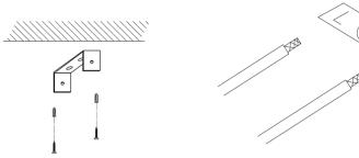
2. Ubique el área donde va a instalar el luminario y haga un orificio para el cable de alimentación. Fije la base de sujeción.
