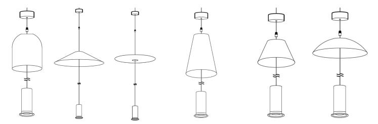
Pase el cable de la lámpara por el orificio central de la pantalla.
