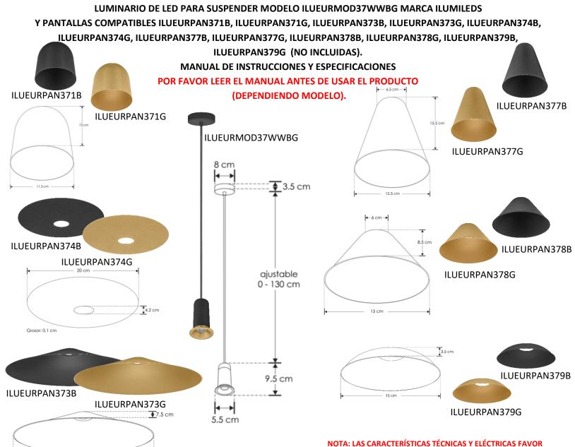
Luminario tipo módulo para suspender en techo, con opción de pantallas intercambiables (No incluidas, el módulo y las pantallas se venden por separado).
