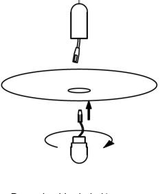
Pase el cable de la lámpara por el orificio central de la pantalla.
