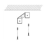
2. Ubique el área donde va a instalar el luminario y haga un orificio para el cable alimentación. Fije la base de sujeción.
