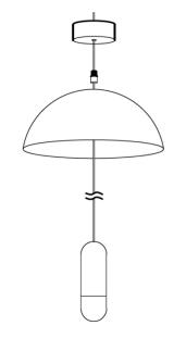
Pase el cable de sujeción por el orificio central de la pantalla.
