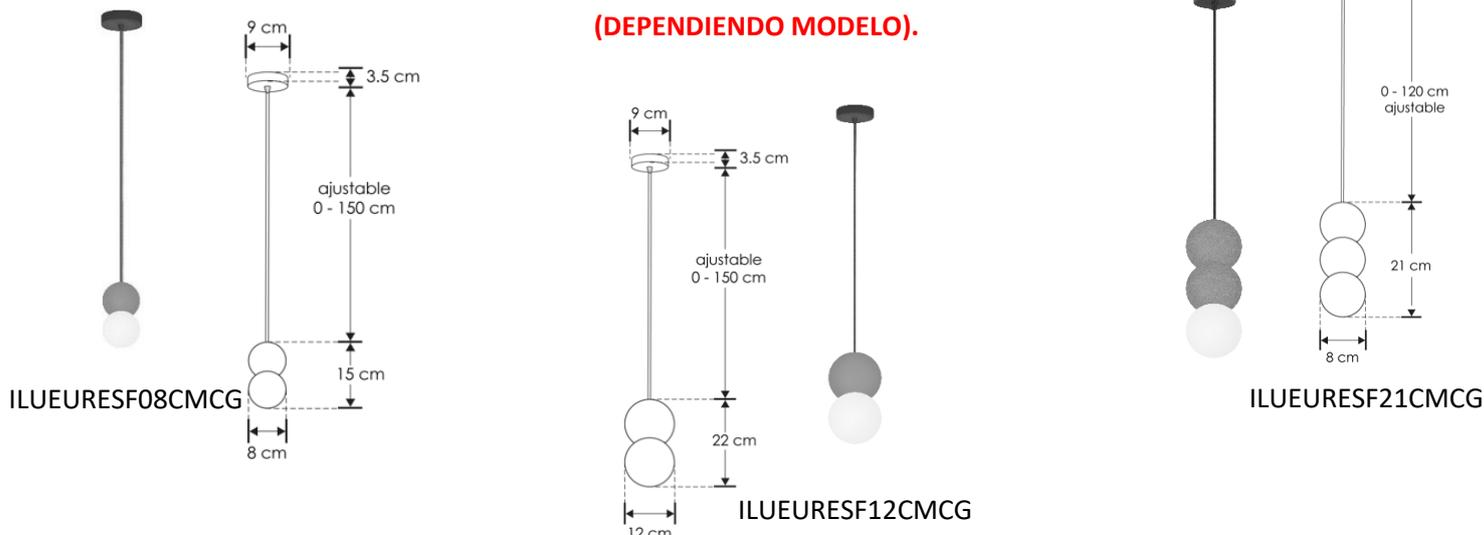
Este producto se usa como elemento de iluminación suspendido en techo (Incluye canope para sobreponer), incluye base G9 (no incluye lámpara). Características de la base G9 incluida: 277 V ~ 15 W (0.12 A) máximo 50/60Hz
