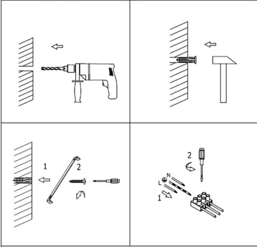
1. Haga perforaciones en el muro para fijar los soportes de la base.
