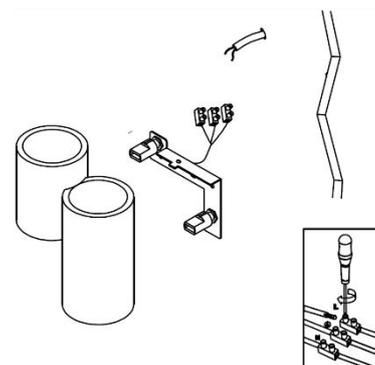
5. Fije el luminario en la base e instale las lámparas (no incluidas). Encienda y pruebe el funcionamiento.
