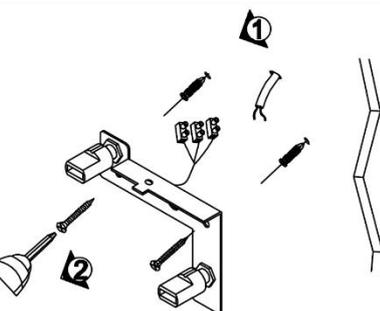
3. Pase el cable de alimentación a través del muro y de la base de sujeción.
