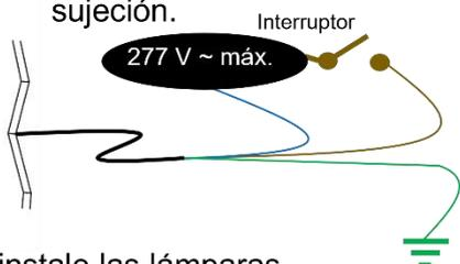
4. Conecte los cables de alimentación en los bornes del luminario.
