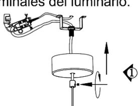
5. Asegure el cable de suspensión de acuerdo con la longitud deseada, guarde la caja de conexiones y el exceso de cable dentro del canope.
