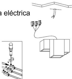
2. Ubique el área donde instalará el luminario y pase los cables de alimentación. Conecte los cables de alimentación en los bornes del luminario
