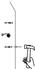
2. Haga un orificio en la superficie y saque los cables de alimentación. Coloque taquetes para fijar
