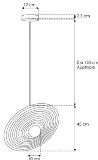
Este producto se usa como elemento de iluminación suspendido en techo (Incluye canope para sobreponer), incluye base G9 (no incluye lámpara). Características de la base G9 incluida: 277 V ~ 15 W (0.12 A) máximo 50/60Hz
