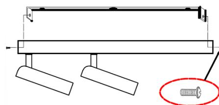
3. Fije el luminario a la base de sujeción con los tornillos laterales pasando los cables de alimentación
