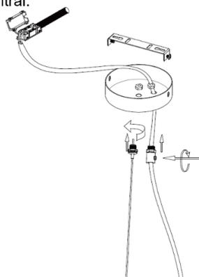
4. Ajuste la longitud de los cables y realice las conexiones eléctricas. Ensamble el canope.
