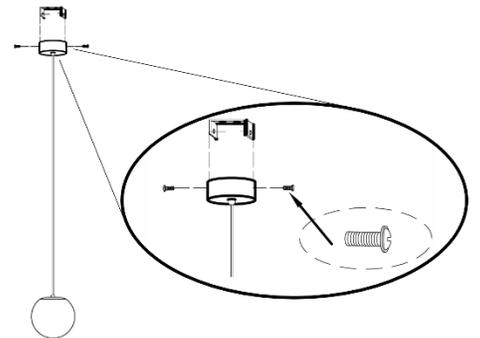
2. Ubique el área donde va a instalar el luminario y haga un orificio para el cable de alimentación. Fije la base de sujeción.
